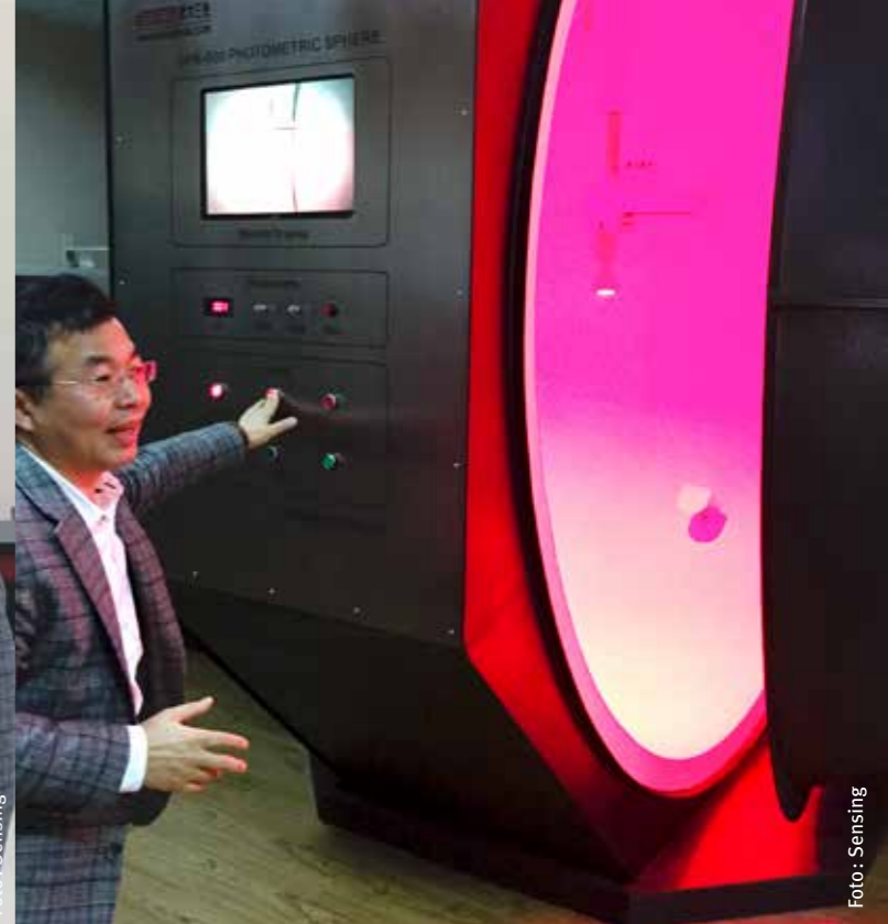
Prof. Mou señala una esfera fotométrica que sirve para medir la eficacia luminosa y el rendimiento de color de una fuente de luz.
